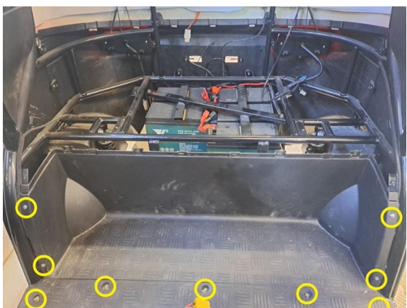
Irrota takajalkatilan kiinnitysruuvit (ristipäämeisseli ph2) ja kiinnityspultit. (hylsy 8 mm).
