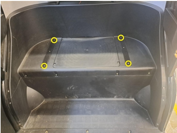
Irrota velcro tarranauhojen reunimmaisiet kiinnitysruuvit. (ristipäämeisseli ph2).
